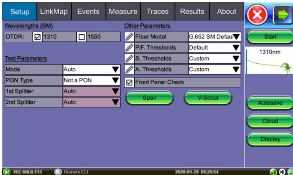
OTDR Setup: FX150 Auto Mode
